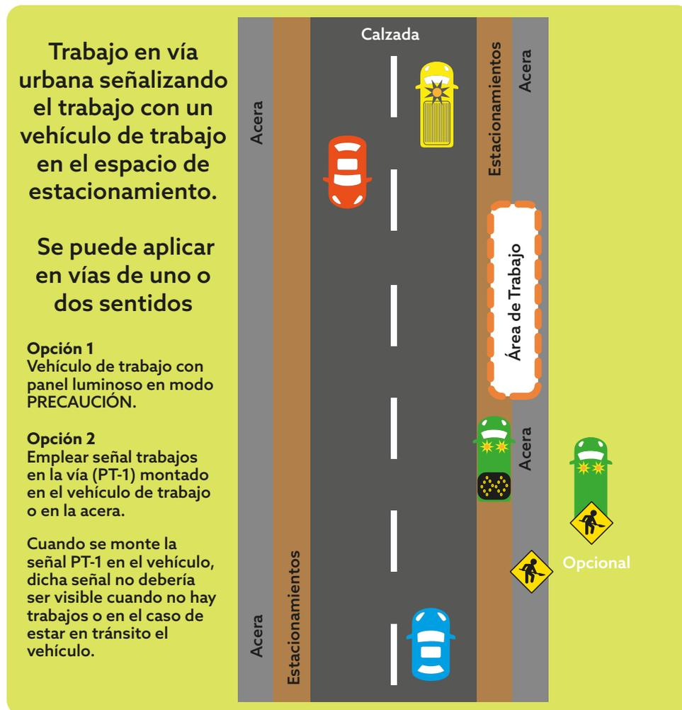
Figura 13 - Uso de vehículo estacionado como señalización de obra
