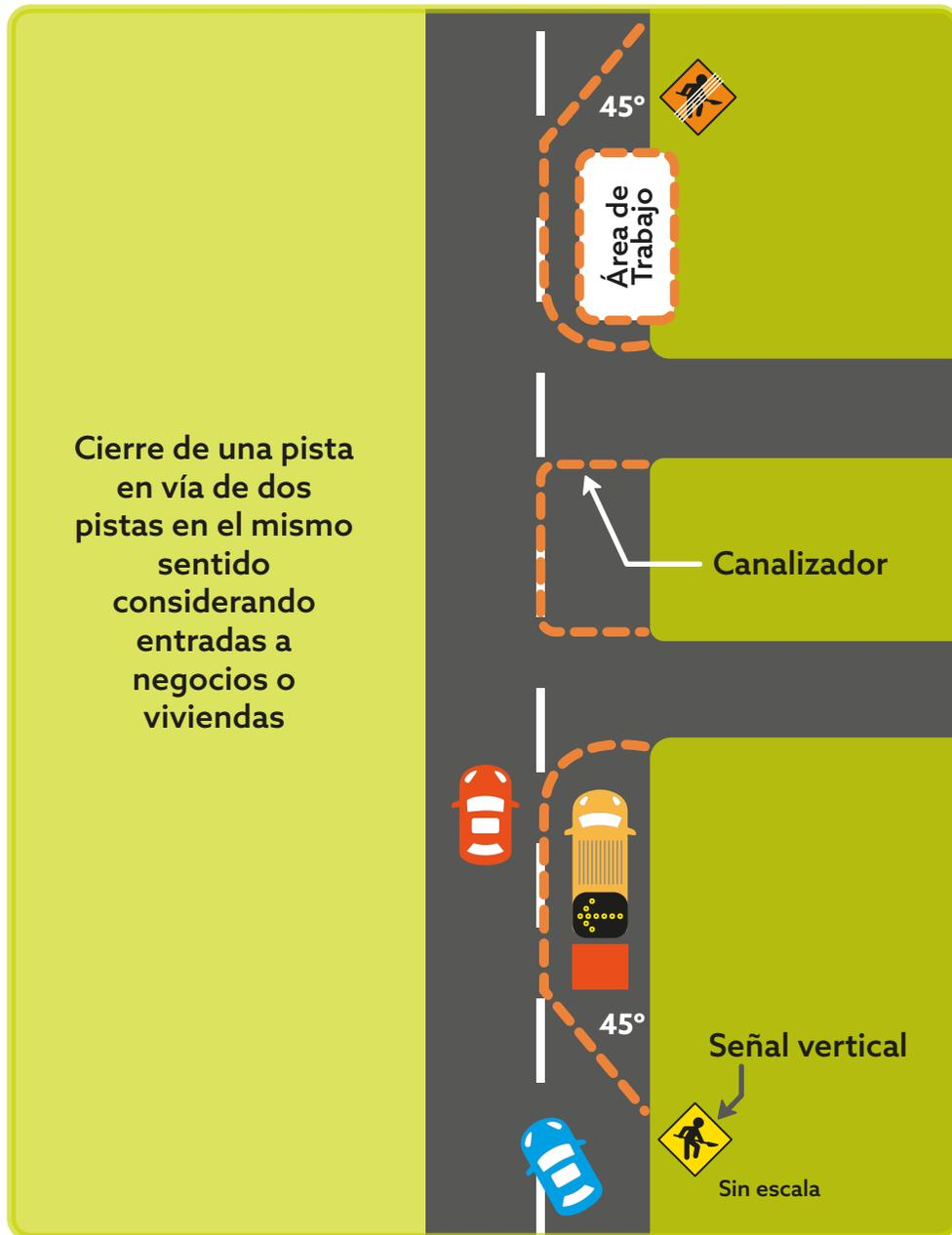
Figura 14 – Cierre de pistas con intersecciones
