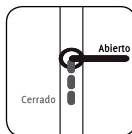
Figura 13: Una llave de frenos en una locomotora (accidente de Lyon)
