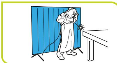
10. Para máquinas y equipos que generan proyección de partículas y/o chispas, utilizar anteojos o gafas de seguridad y también pantallas que eviten el contacto con compañeros de trabajo.
